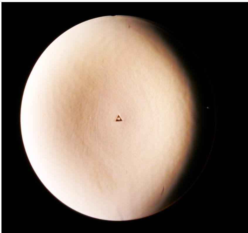
Ruw oppervlak (Foucaulttest) 40 cm spiegel als boven, voor Verbetering.
